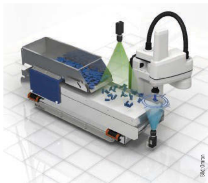
Der Any Feeder kombiniert Teilezuführung, Kamera-basierte Lageerkennung und Picking.
